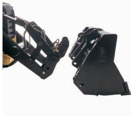
**Acoplador rápido del cargador.**
