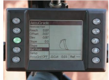
**Pantalla en la cabina.** El monitor AccuGrade permite que el operador ingrese los parámetros de rasante y profundidad de excavación. La pantalla en la cabina, con indicador de rasante de fácil lectura y visualizador de levantamiento, proporciona toda la información del sistema en la cabina para que el operador la vea fácilmente.
