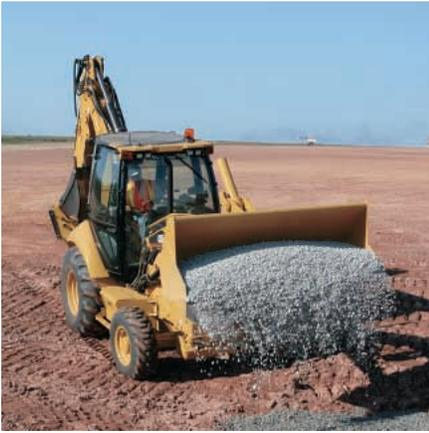
**Varillaje del cargador de inclinación sencilla.** El varillaje del cargador de inclinación sencilla ofrece grandes fuerzas de levantamiento y separación para obtener un rendimiento consistente en aplicaciones de relleno y carga de camiones. La máquina se equipa con un cucharón de uso general o con uno de uso múltiple para adaptarse a sus necesidades específicas.
